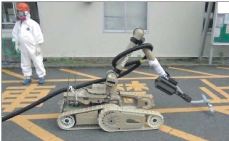
ДУМ «Уорриор 710» с оборудованием для очистки помещений реактора атомной электростанции
