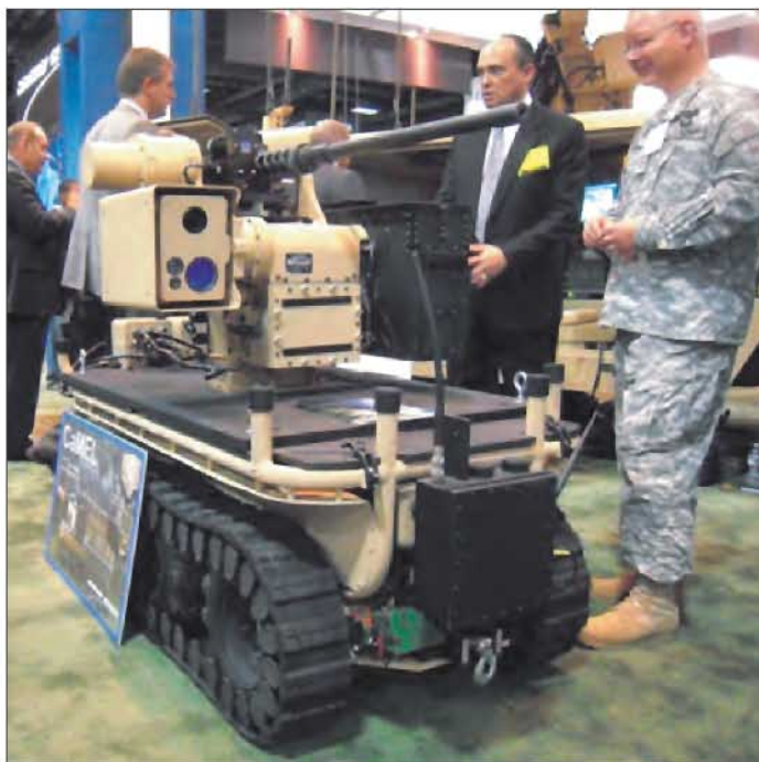
Демонстрационный образец ДУМ «Кэмел», представленный на выставке AUSA 2010, оснащен модулем вооружения CROWS
