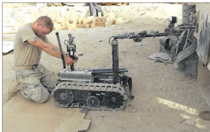
Американский военнослужащий в Афганистане осуществляет техническое обслуживание ДУМ «Талон», предназначенной для обследования и обезвреживания самодельных взрывных устройств
