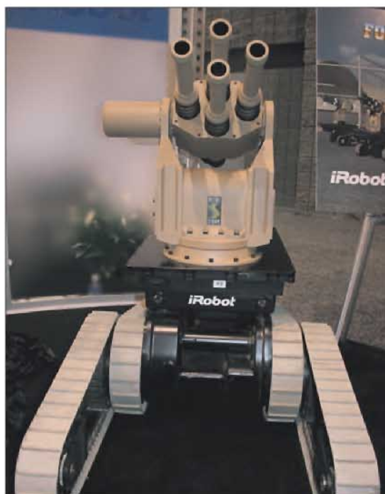
Боевая ДУМ «Уорриор 700» с двумя автоматическими винтовками АА-12 (вверху) и гранатометной установкой FireStorm (внизу)
