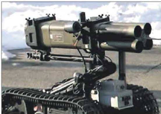
Варианты вооружения ДУМ «Талон»: с 66-мм пусковой установкой M202 (слева) и 40-мм шестиствольным гранатометом (справа)
