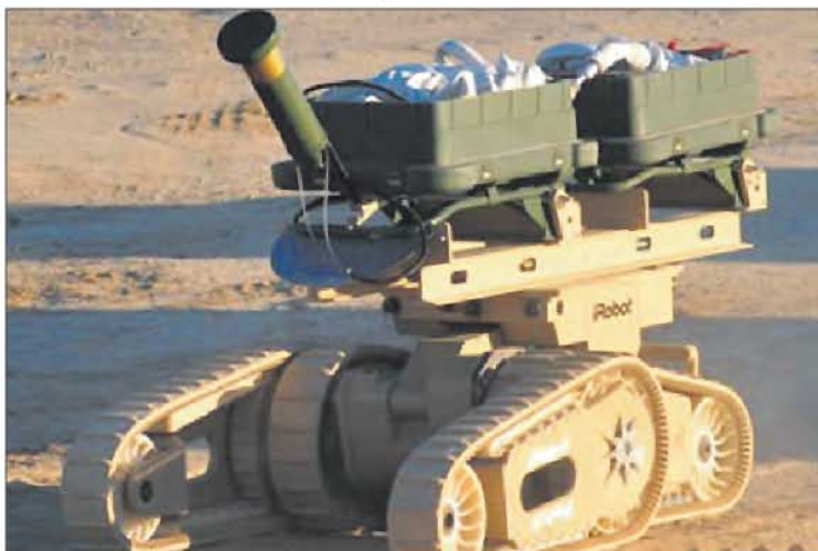
ДУМ «Уорриор 710» с системой разминирования APOBS
