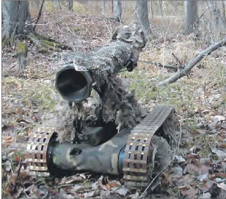
ДУМ «Талон», вооруженная противотанковым гранатометом АТ4
