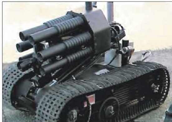
Варианты вооружения ДУМ «Талон»: с 66-мм пусковой установкой M202 (слева) и 40-мм шестиствольным гранатометом (справа)
