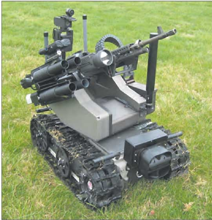
ДУМ MAARS, оснащенная блоком вооружения, включающим 7,62-мм пулемет и четыре 40-мм гранатомета
