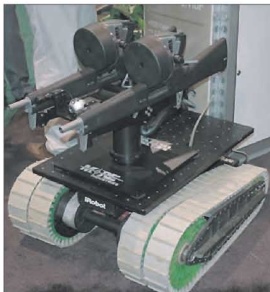
Боевая ДУМ «Уорриор 700» с двумя автоматическими винтовками АА-12 (вверху) и гранатометной установкой FireStorm (внизу)
